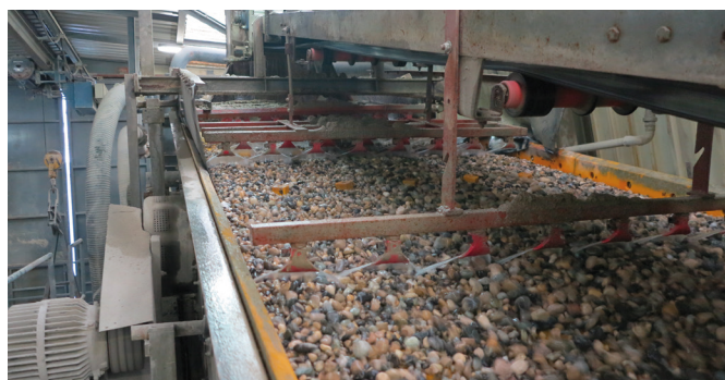
Installation de lavage du gravier à l'étage supérieur
