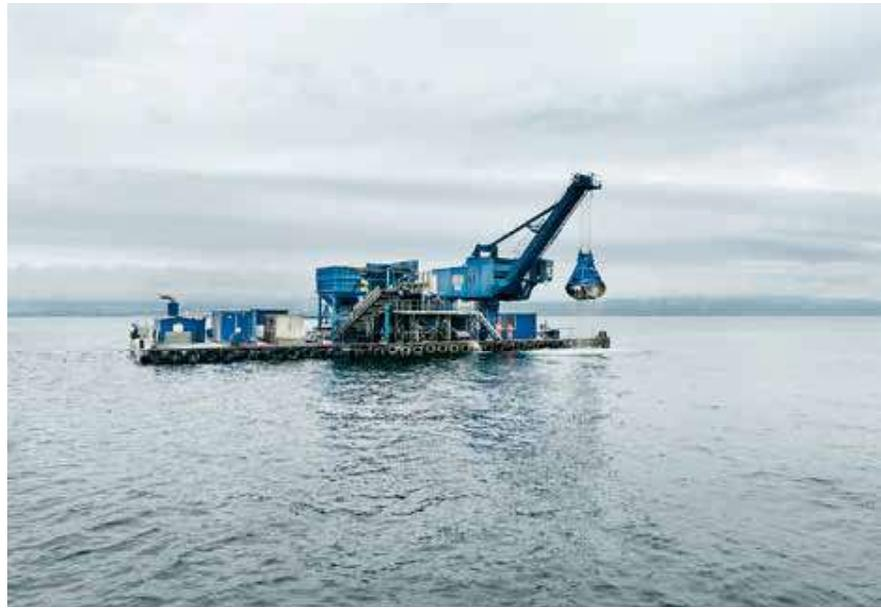
C'est depuis cette plateforme mobile que l'entreprise Sables et Gravier La Poissine extrait 340 000 tonnes de gravier et de sable par an du lac de Neuchâtel. Mais elle n'a trouvé encore aucune pépite d'or!
